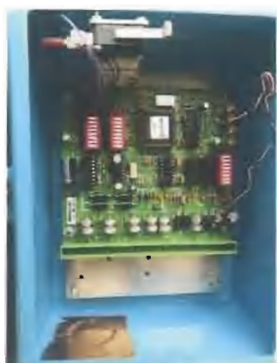
图 17: 防水试验后内部情况
