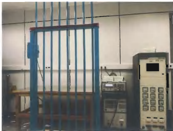
图 24: 电快速瞬变脉冲群抗扰度试验照片
