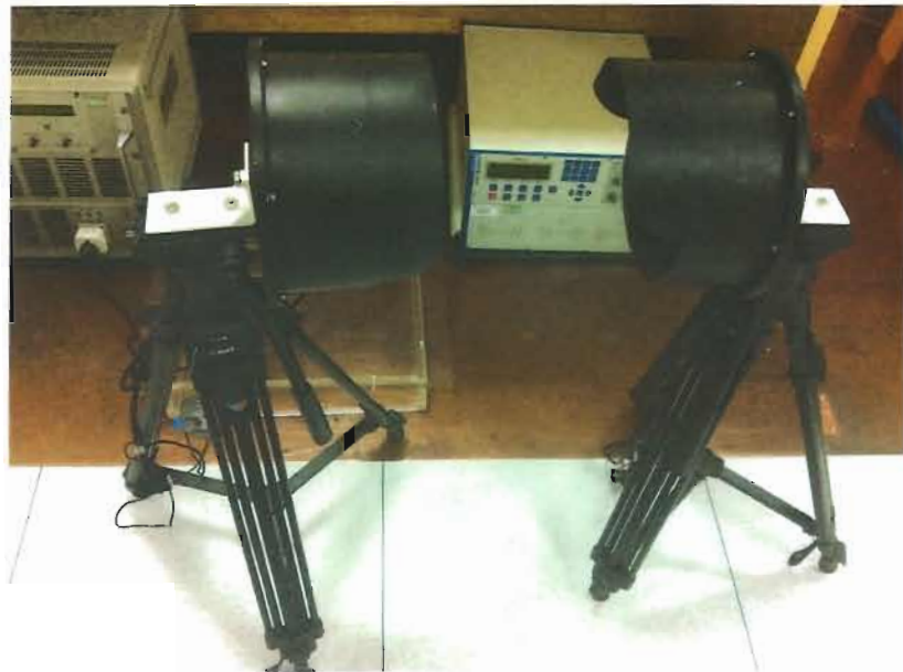
图九：浪涌（冲击）抗扰度试验检测布置图
