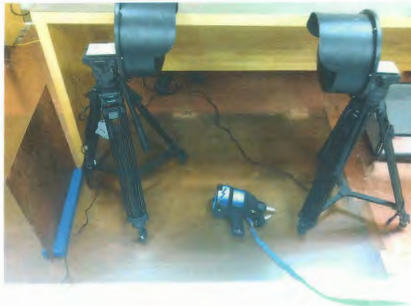
图三：静电放电抗扰度试验检测布置图
