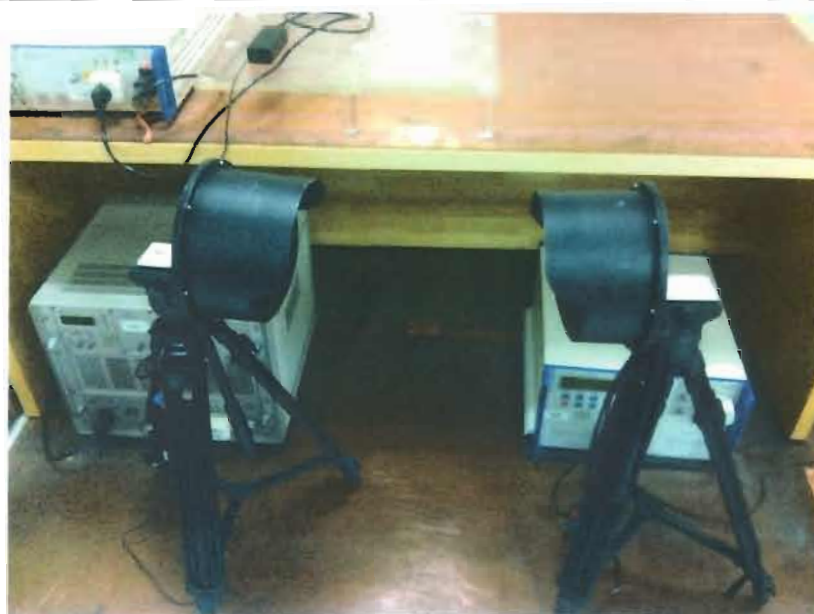
图七：电快速瞬变脉冲群抗扰度试验检测布置图
